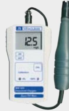
Das tragbare Sauerstoffmessgerät MW600 ermöglicht eine schnelle und zuverlässige Bestimmung des gelösten Sauerstoffs in Wasser. Ideal für den Einsatz in Teichen, Aquarien und der Fischzucht. Dank der einfachen Luft-Kalibrierung und der automatischen Temperaturkompensation liefert das Gerät präzise Messergebnisse.
