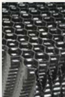
Die Filterwaben sind die perfekte Lösung für Rieselfilter und untergetauchte Biokammern in Teichfiltern. Mit einer aktiven Oberfläche von 240 m<sup>2</sup>/m<sup>3</sup> und kompakten Abmessungen von 600 x 300 x 300 mm bieten sie eine effektive Besiedlungsfläche für nützliche Bakterien. Das Gewicht von 29 kg/m<sup>3</sup> sorgt für Stabilität im Filter.
