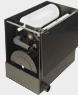
Die EVO-Filterssysteme von GENESIS sind ihrer Zeit weit voraus. Dank der Nutzung der Wasserkraft arbeiten sie völlig stromlos und nahezu verschleißfrei. Das patentierte Funktionsprinzip sorgt für eine effiziente und wartungsarme Filtration: Das Teichwasser wird entweder per Schwerkraft oder über eine Pumpe in die Filtertrommel geleitet, welche mit Vlies umspannt ist. Partikel, die größer sind als einige Mikrometer, werden hier zuverlässig zurückgehalten.
