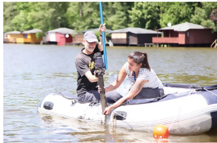
Mit dem Schlammprobennehmer kann die Probe mit den unterschiedlichen Sedimentschichten entnommen werden.
