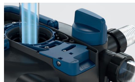
Gezielte Ableitung von Schmutzwasser: Über das 2-Wege-Ventil wird das Schmutzwasser aus den gereinigten Filterschwämmen zum Beispiel ins Blumenbeet abgelassen.
