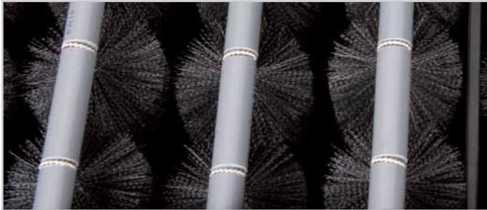
Durch die Wellenform der Bürstenhaare ergibt sich eine deutliche Vergrößerung der Oberfläche. Dies bewirkt eine noch feinere Filtration, erhöht die Schmutzaufnahme und steigert die ohnehin schon beträchtliche Lebensdauer.
