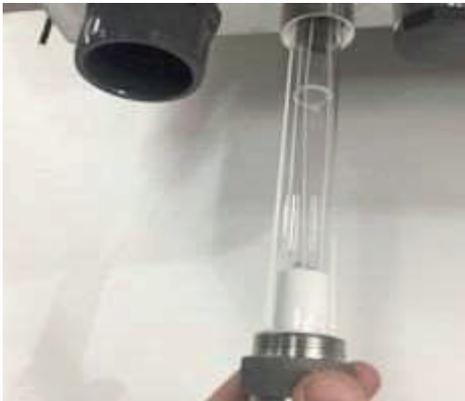
4. Führen Sie die UVC nun vollständig in den UV-Anschluss ein.
