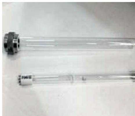
2. Führen Sie das Leuchtmittel vorsichtig in das Quarzglas ein (Bruchgefahr). Führen Sie nun Quarzglas der UV-Lampe in den Filter ein.
