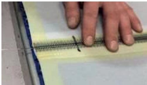
8. Führen Sie das nicht gebogene Ende des Verschlussdrahtes durch den Reißverschluss.
