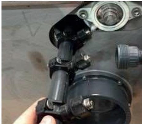
4. Schieben Sie den Ersatzdüsenstock wieder in den Filter.
