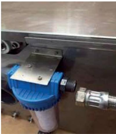
1. Umwickeln Sie das Anschlussgewinde auf der rechten Ausgangsseite des Vorfilters mit Teflonband.
