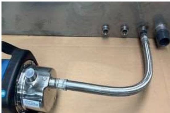
➡ Die Spülpumpe ist angeschlossen und kann nun mit dem Vorfilter verbunden werden
