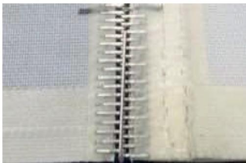
10. Stellen Sie sicher, dass beide Drahtenden am Reißverschluss flach angelegt sind.
