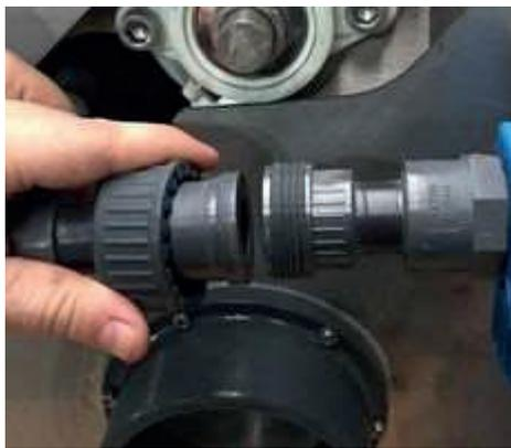
6. Drehen Sie den Verschlussring am Düsenstock wieder zu.
