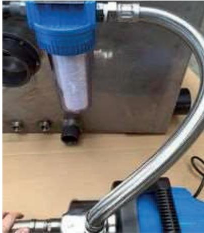
➡ Der Vorfilter kann nun von der Spülpumpe mit Wasser versorgt werden.
