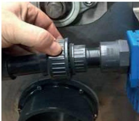
5. Drehen Sie den Verschlussring am Düsenstock wieder zu.
