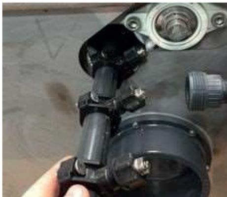
2. Ziehen Sie den Düsenstock aus dem Filter.
