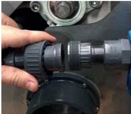
1. Drehen Sie den Verschlussring am Düsenstock auf.
