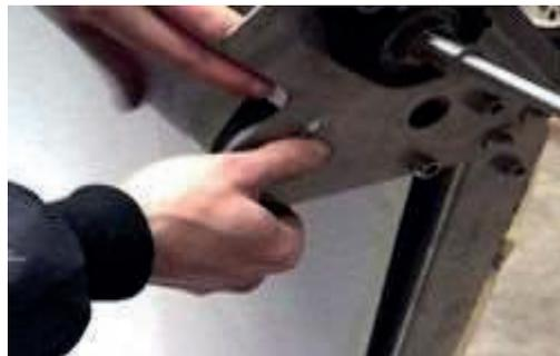
12. Richten Sie die Umlenkrolle an einem Ende mit einer Justierschraube aus.
