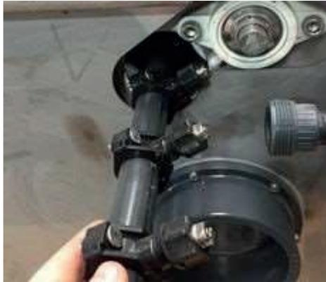
5. Schieben Sie den Düsenstock wieder in den Filter.
