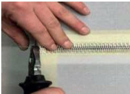
9. Biegen Sie das nicht gebogene Ende des Verschlussdrahtes auf 2cm Länge flach an den Reißverschluss.
