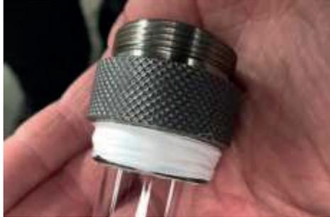
3. Umwickeln Sie das Gewinde des Quarzglas mit Teflonband.
